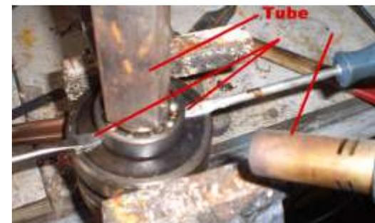
Si cela ne vient pas, il faut se résoudre à couper le roulement à la scie, en prenant le maximum de précautions pour ne pas entamer l'axe. Mais bien souvent si on en arrive à cette extrémité, c'est pour constater la soudure des pièces, l'axe sera
