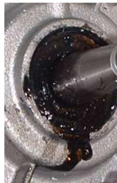
Un roulement resté sur l'axe se retire à l'aide d'un extracteur. Si l'espace entre les pièces ne permet pas le passage des fourches, utiliser un "arrache-roulements" ou forcer en enfonçant entre la masselotte et le roulement deux tournevis plats opposés (photo 3). Lorsque la pièce a été suffisamment
